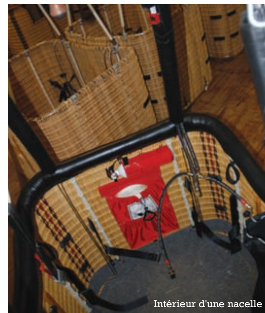
Paniers en osier (tressé verticalement)
